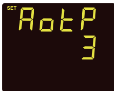
Fig 3-19 AO1 Parameter Setting
