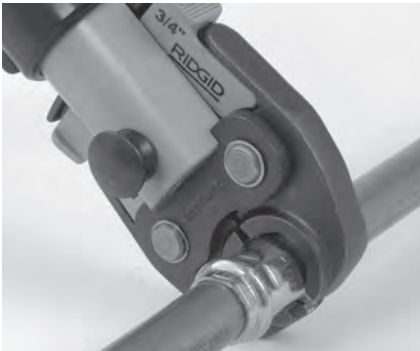
Abbildung 7 – Anbringen Pressbacke an Fitting
