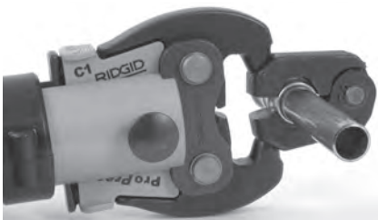
Abbildung 10 – Ansetzen der Ringbacke am Pressring
