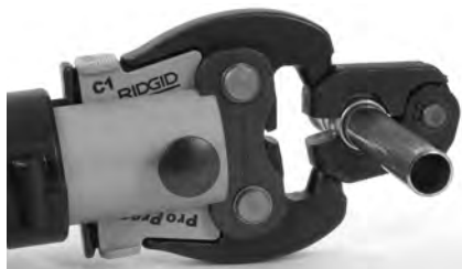
Figura 10 – Montaje del accionador en el aro sellador
