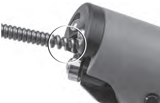
Figura 9 – Separaciones en el bobinado del cable en el extremo final del cable
