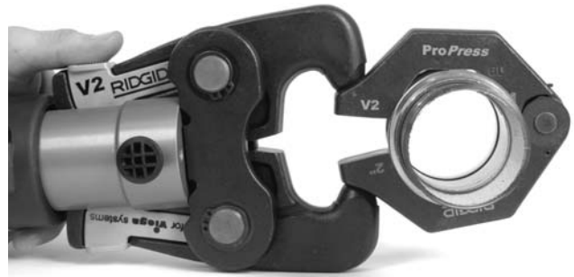
Figura 9 – Montaje del accionador en el aro sellador
