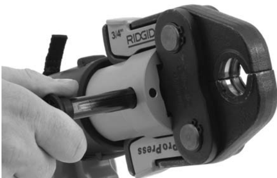
Figure 4 – Goupille de sécurité d'accessoire complètement ouverte
