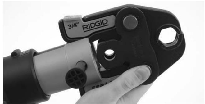
Figure 5 – Glissement de l'accessoire dans l'appareil
