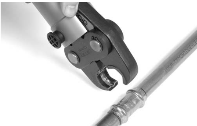
Figure 6 – Ouverture des mâchoires à ciseaux
