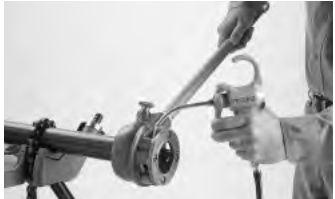
Figura 4 – Aceitado con aceite para cortar roscas
