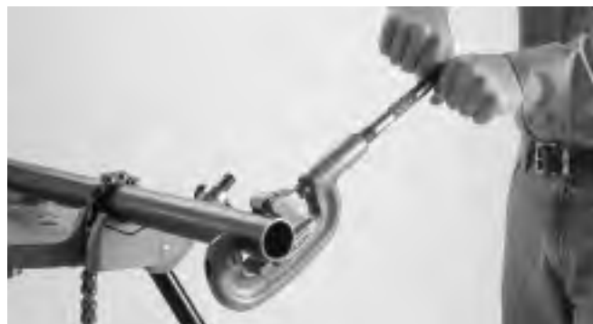
Figura 1 – Corte del extremo del tubo
