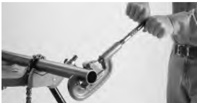
Figure 1 – Coupe de l'extrémité du tuyau
