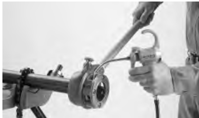
Figure 4 – Application de l'huile de coupe
