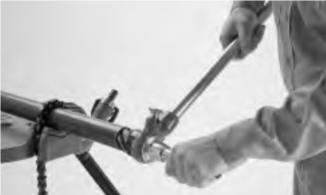
Figura 2 – Escariado del extremo del tubo
