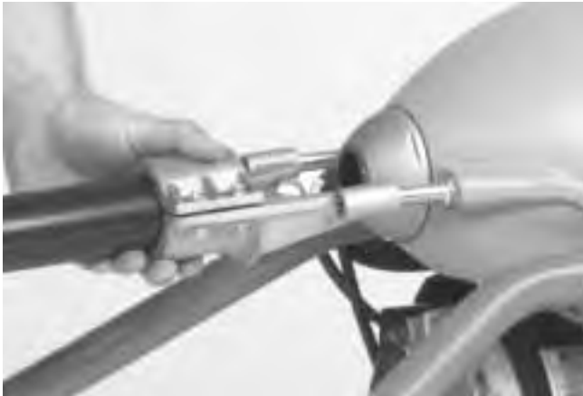
Figure 3 – Montage du guide-câble arrière
