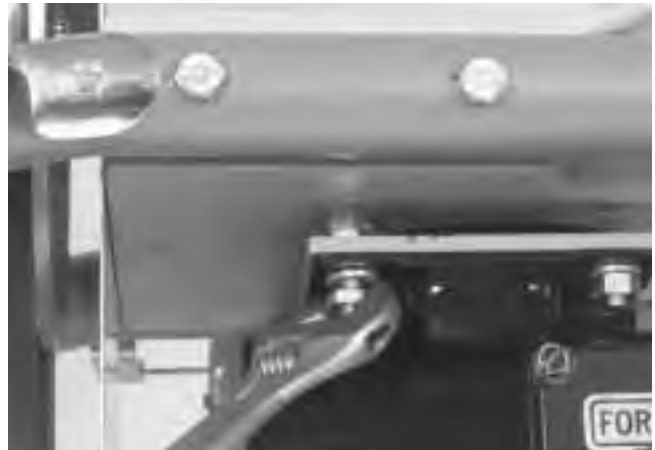
Figura 14 – Eliminación del juego (holgura) del embrague
