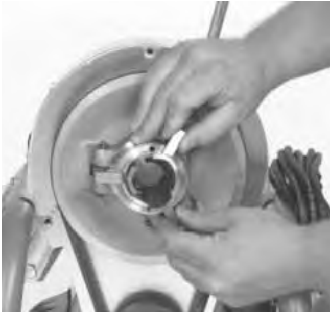
Figura 13 – Recambio de las mordazas del embrague
