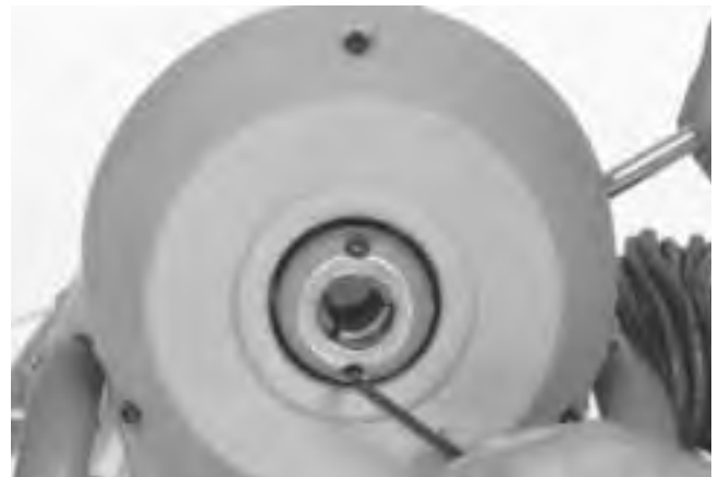
Figura 12 – Recambio de las mordazas del embrague
