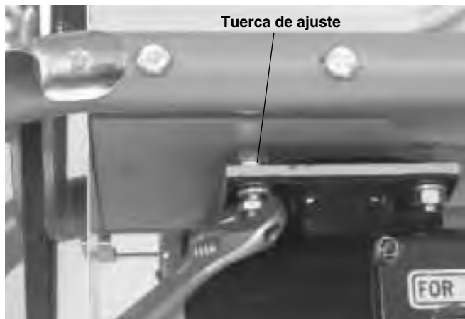
Figura 15 – Regulación de la correa trapezoidal
