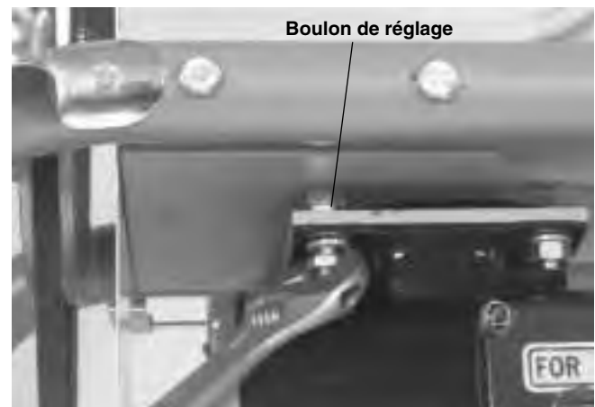
Figure 15 – Réglage de la courroie d'entraînement
