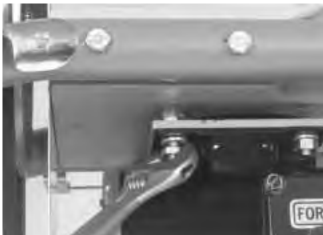
Figure 14 – Élimination du jeu de l'embrayage
