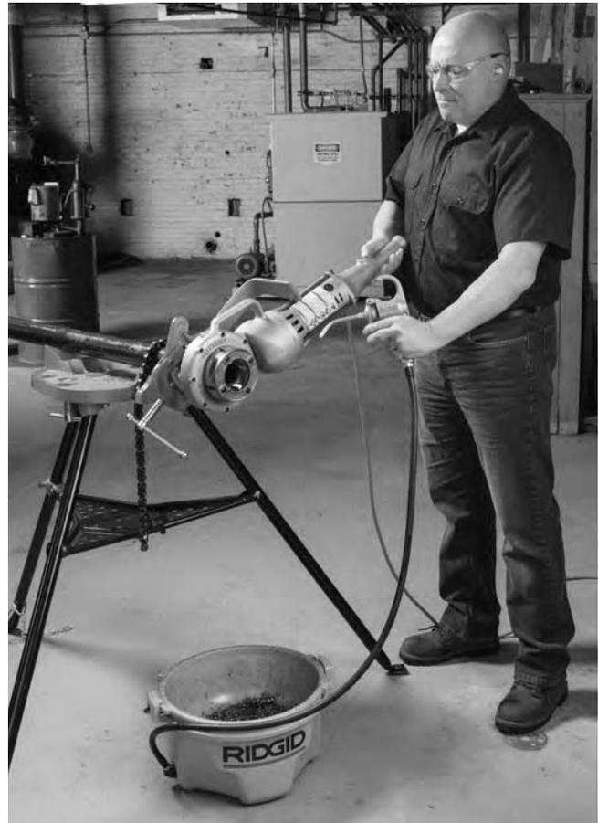
**Figure 9 – Filetage des tuyaux**
