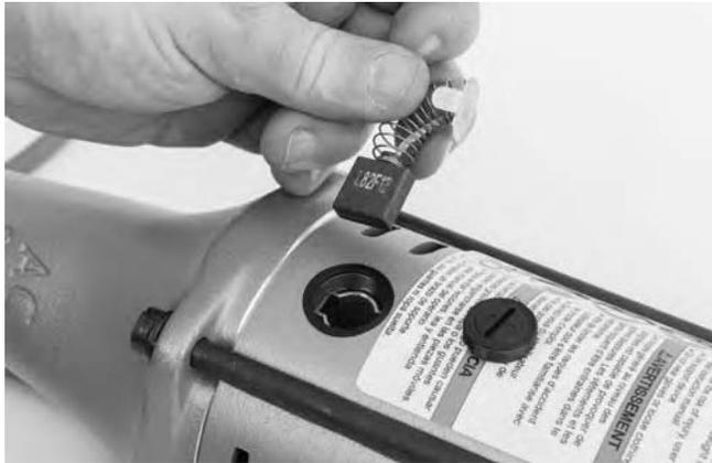
Figure 13 – Installation des balais
